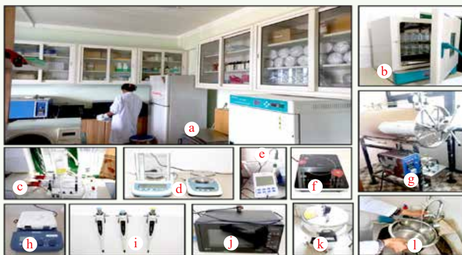
चित्र ४: (a) मिडिया बनाउने कोठा र यस कोठामा प्रयोग गरिने उपकरणहरू; (b) हट एयर ओभन, (c) डबल डिस्टिलेसन एकाइ, (d) डिजिटल तौल मेसिन, (e) पीएच मीटर, (f) विद्युतिय चुला, (g) र (k) अटोक्लेभ, (h) चुम्बकीय उत्तेजक, (i) पिपेट, (j) माइक्रोवेव ओभन, (l) बेसिन
