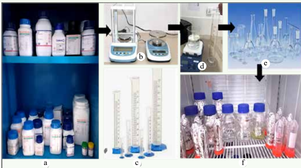
चित्र २०: मुरासिगे-स्कूग स्टक सोलुसन बनाउने तरिका (a) मिडिया बनाउन आवश्यक रसायानहरू, (b) आवश्यक मात्रामा रसायान तौलिने (c) Measuring cylinder, (d) रसायानहरूलाई पानीमा राम्ररी घोल्ने, (e) डिस्टिल पानी थप्ने आवश्यक सोलुसनको मात्रा बनाउने र (f) तयार गरिएको स्टक सोलुसनलाई सुरक्षित फ्रिजमा (४-८) डिग्री तापक्रममा भण्डारण गर्ने
