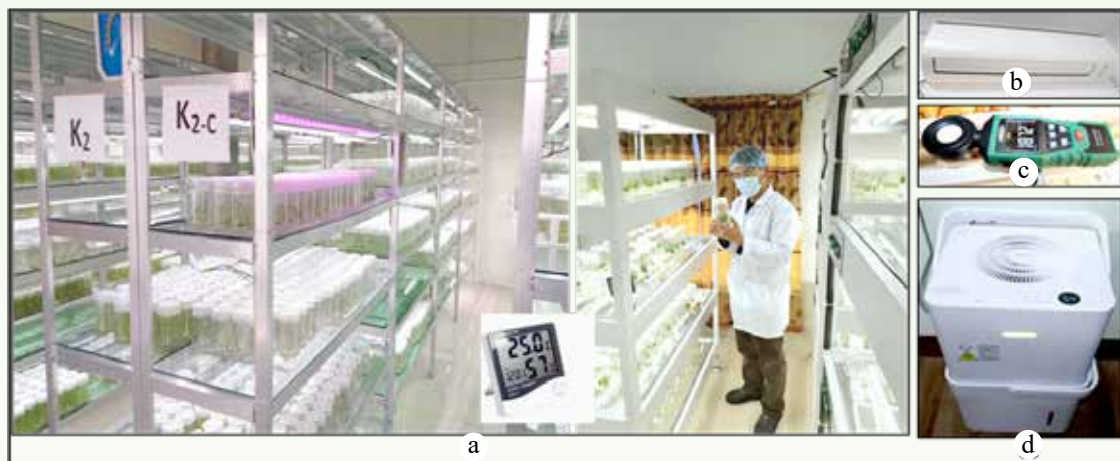
चित्र ६: बिरुवा हुर्काउने कोठाको सुविधा तथा उपकरणहरू; (a) बिरुवहरू राख्ने लाईट सिस्टम जडित कल्चर यार्कहरू (b) AC, (c) लक्स मीटर र (d) dehumidifier
